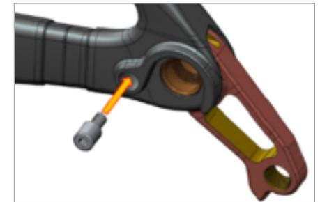
Insira o Segundo parafuso de fixação na traseira do dropout conforme imagem (Torque máximo 1.5 N/M)
