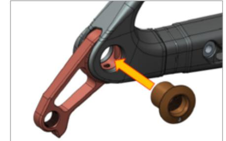
Insira a tampa de fixação do dropout através do quadro e do dropout substituível.
