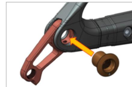
Schieben Sie die Gewindebuchse von außen durch die Rahmenbohrung und das Ausfallende.
