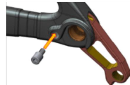
Bitte montieren Sie den 2ten Befestigungsbolzen an der Rückseite des Ausfallendes mit einem max. Drehmoment von 1.5Nm.
