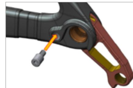
Insira o Segundo parafuso de fixação na traseira do dropout conforme imagem (Torque máximo 1.5 N/M)
