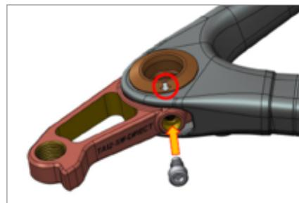
Certifique-se que a seta de marcação na tampa de fixação do dropout está na posição correta (conforme imagem acima) a apontar para o local de entrada do parafuso de fixação. A (Torque máximo 1.5 N/M)
