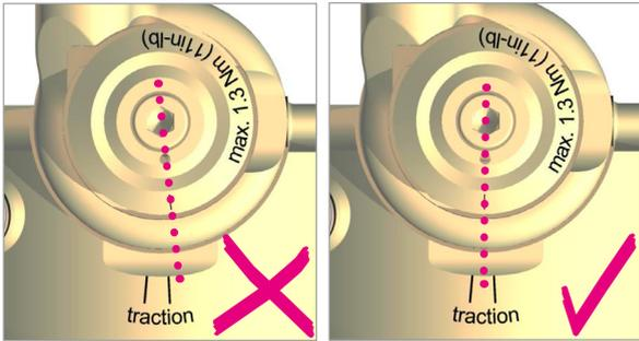
4. Positionnez le levier en mode Traction. La marque sur la came de l'amortisseur doit être positionnée comme illustré ci-dessous.
