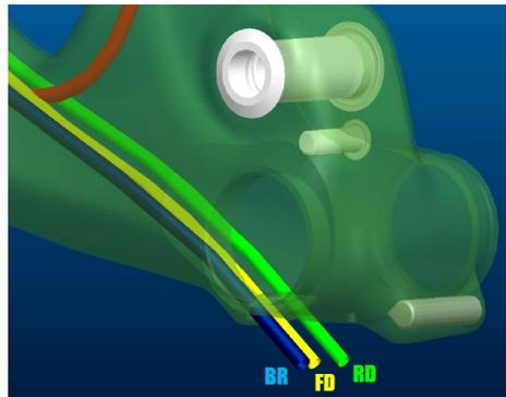
Passez le câble du levier de la tige de selle télescopique dans le cadre (version stealth) vers la tige de selle ou faites-le passer le long du tube oblique en direction de la tige de selle.
