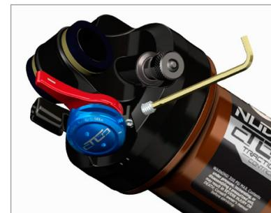
1. Desserrez la vis de fixation du câble (S7) en tournant dans le sens contraire des aiguilles d'une montre à l'aide d'une clé Inbus de 2mm.
