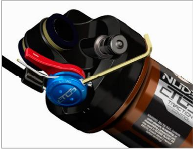
3. Tendez le câble et fixez-le en vissant la vis de fixation (S7), en tournant dans le sens des aiguilles d'une montre, à l'aide d'une clé Inbus 2 mm, au couple maximum de 1.6 Nm.
