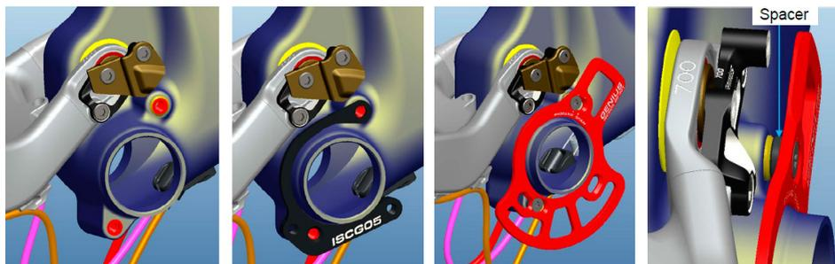
Le guide chaîne doit être monté exactement comme illustré en utilisant toutes les pièces du set.
