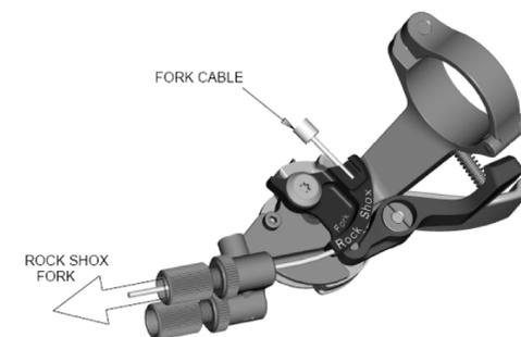
2. Fixez le câble avec une clé Inbus 2 mm sur le mécanisme de réglage du Lock-out, sur la partie supérieure droite du Té de la fourche, au couple 0.9Nm/8lb/in. Raccourcissez le câble et assurez-le avec un embout de câble. Référez-vous également au manuel de SRAM / ROCK SHOX joint au bike/à la fourche.
