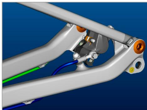
Pour les disques de 185 mm de diamètre, vous devez utiliser deux disques eloxés rouges, qui peuvent être commandés via SCOTT:
