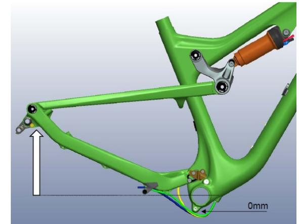
Por favor certifique-se que respeita a distância de 40mm entre o tubo de travão e o bloco pedaleiro de forma a evitar danos ao tubo de travão.
