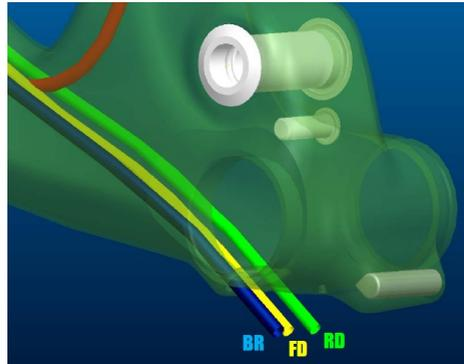
Guie o cabo de controlo remoto do espigão de selim através do interior do quadro para o tubo de selim (stealth) ou puxe o cabo pela traseira do tubo de selim.
