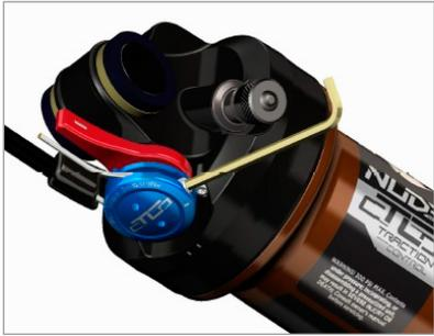
3. Aperte o parafuso de fixação do afinador usando uma chave Allen de 2mm e rodando-a no sentido contrário aos ponteiros do relógio com um torque de aperto Max. de 1.6 Nm.
