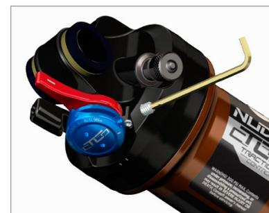
1. Remova o parafuso de cabo (s7) utilizando uma chave sextavada de 2mm rodando o parafuso no sentido contrário aos ponteiros do relógio.
