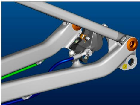
Por favor note que para utilizar rotores de 185 ou 200mm irá necessitar de adaptadores ou anilhas específicas para esse fim entre o apoio Postmount no quadro e a pinça de travão de disco.
