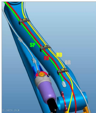
Aperte o parafuso de suporte dos cabos com um torque de 4Nm/35lbs
