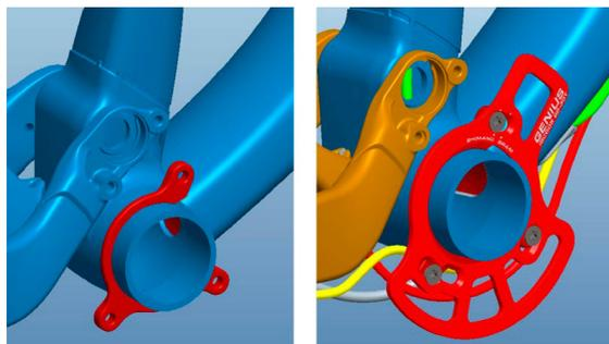
Pode montar o bloqueio de corrente directamente no adaptador ISCG05 ou no bloco pedaleiro.
