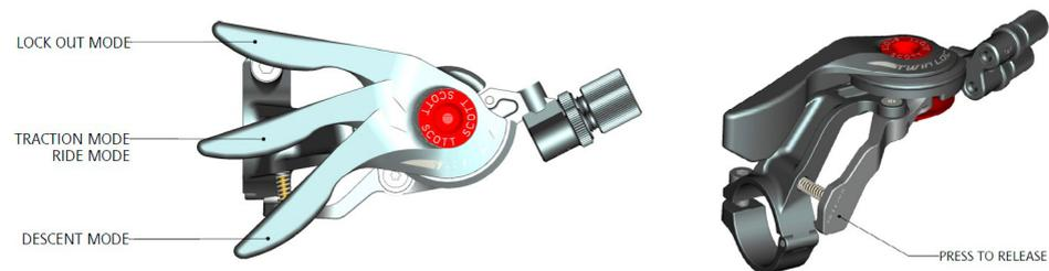
Para a montagem do controlo remoto da suspensão existem dois tipos diferentes de sistema de fixação do cabo que são intermutáveis.
