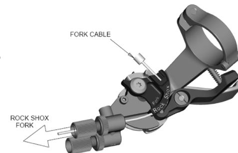
2. Fixe o cabo com uma chave sextavada de 2mm no afinador da suspensão com um torque máximo de 0.9Nm, corte o cabo à medida e coloque por fim um terminal de cabo.
