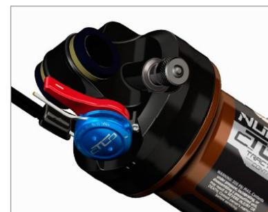
2. Aplique um novo cabo através do orifício do manípulo e através da espiral de cabo e empurre este à volta da roda de controlo remoto (S6)..
