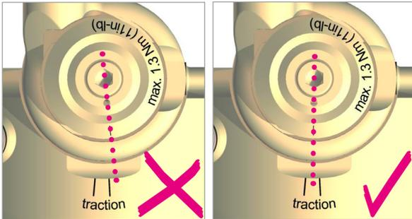
4. Verifique se o manípulo está na posição (modo de tracção) e ajuste a roda de controlo remoto conforme demonstrado na imagem em baixo.
