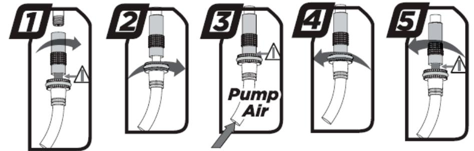
Tome em atenção que cada vez que efectuar uma verificação à pressão do amortecedor deverá repor o ar perdido nesta operação e ajustar novamente a pressão recomendada. Recorde-se sempre que os manómetros das bombas de suspensão possuem uma margem de erro máxima de 10%.
