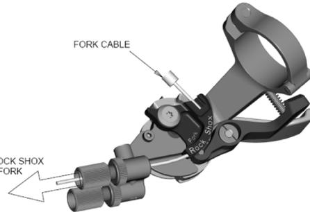
2. Befestigen Sie das Kabel mit einem 2 mm Inbusschlüssel am Verstellmechanismus des Lock-out auf der Oberseite der rechten Seite der Gabelkrone mit einem Drehmoment von 0.9Nm/8lb/in, kürzen Sie das Kabel und sichern Sie es mit einer Kabelendhülle. Bitte beachten Sie hierzu auch die dem Bike/der Gabel beiliegende Bedienungsanleitung von SRAM/RockShox oder FOX
