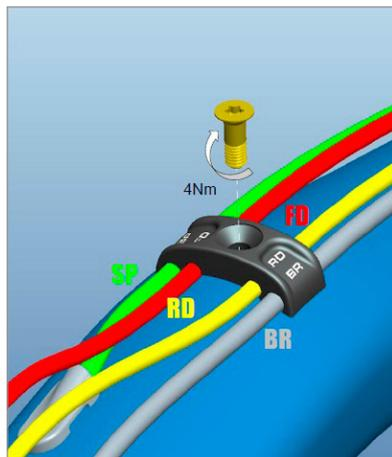
Bitte vergewissern Sie sich, dass mindestens 40mm Abstand zwischen den Hüllen und dem Tretlagergehäuse ist, um "ghost-shifting" und/oder Schäden am Rahmen oder den Schalt-/Bremseleitungen zu vermeiden.
