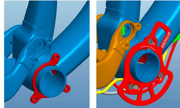
Sie können den Chainblocker direkt an der integrierten ISCG 05 Aufnahme am Tretlagergehäuse verschrauben.
