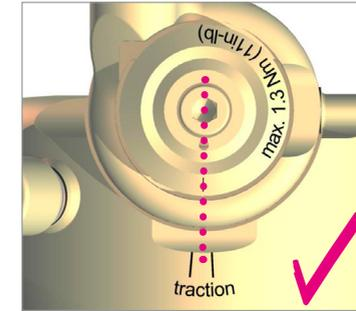
4. Bringen Sie den Fernbedienungshebel am Lenker in die Traction Mode Position. Nun sollte die Markierung der Kabelrolle am Dämpfer wie untenstehend abgebildet positioniert sein.
