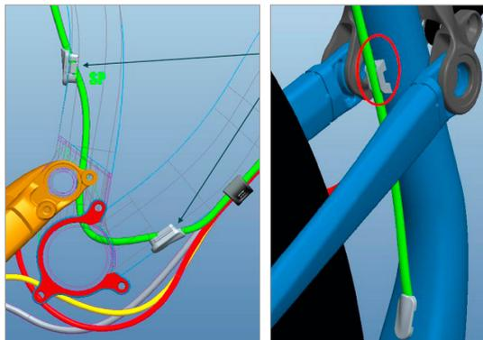
Die Gummiabdeckung am Rahmen sollte zum versiegeln der Kabelgänge genutzt werden.
