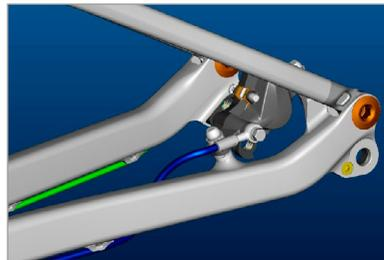
Für 185mm Scheibendurchmesser benötigen Sie 2 rot eloxierte Distanzscheiben, die mit Teilenummer über die SCOTT Distribution bestellt werden können:
