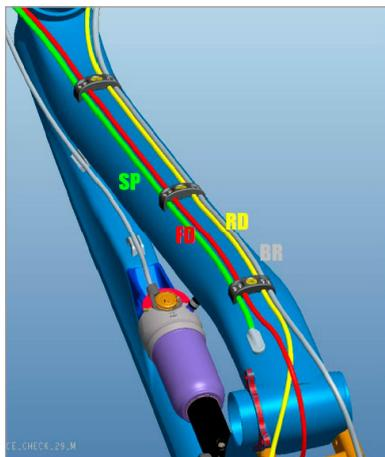
Bitte beachten Sie das maximale Anzugsdrehmoment der Schraube von 4Nm.
