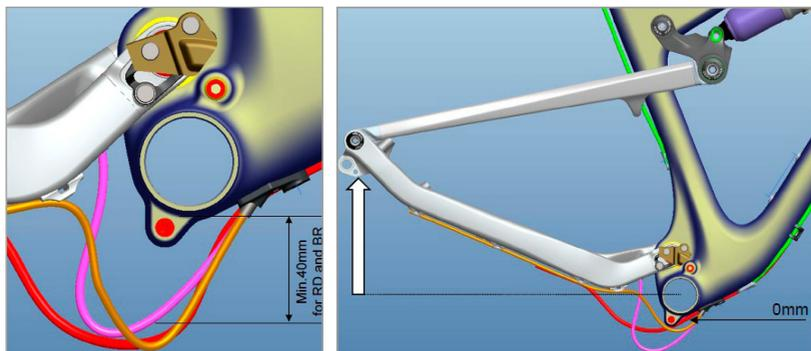
Bitte montieren Sie die Leitung der hinteren Bremse wie folgend abgebildet:
