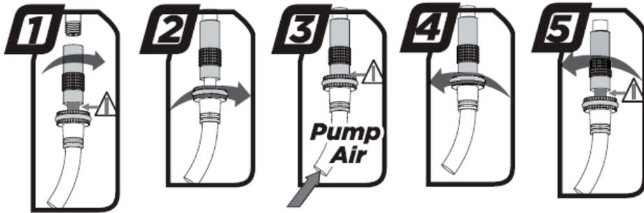
Bitte beachten Sie, dass Luft aus dem Dämpfer in den Pumpenschlauch und die Druckanzeige strömt, wenn Sie den Luftdruck überprüfen. Somit ist ein Nachpumpen nötig, um den ursprünglichen Druck im Dämpfer wieder herzustellen.
