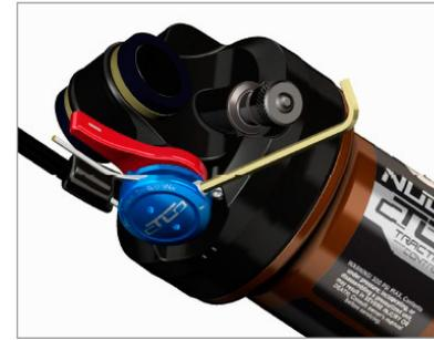
3. Straffen Sie das Kabel und drehen Sie die Kabelbefestigungsschraube (S7) im Uhrzeigersinn mit einem 2mm Inbusschlüssel mit einem maximalen Drehmoment von 1.6Nm.
