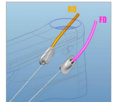
Bitte beachten Sie, dass die Kabel sich im inneren des Rahmens einmal kreuzen müssen bevor Sie sie durch den Kabelführungsschlitz am unteren Ende des Unterrohres herausziehen.
