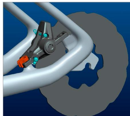
O apoio de travão de disco traseiro nos quadros scale é do tipo “post mount”, localizado na escora inferior esquerda e foi otimizado para usar rotores de 160mm. Como tal neste caso a pinça de travão pode ser montada directamente no quadro sem o uso de um adaptador.
