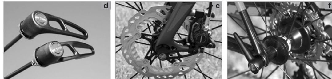
Halten Sie die Klemmmutter auf der rechten Seite der Nabe fest. Drehen Sie dann den RWS-Spannhebel im Uhrzeigersinn, um das RWS-System vorzuspannen. Je nach eingebauter Gabel bzw. je nach Rahmenmodell sind mindestens sechs meist jedoch mehrere Umdrehungen erforderlich. Die ersten Umdrehungen muss sich der RWS-Spannhebel leicht drehen lassen.
