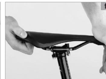
Beim **Ein-Schraubensystem (a)** ist die Sattelstütze für die meisten Sportsättel mit einem Sattelgestellrohrdurchmesser von 7 mm ausgelegt. Ebenfalls erhältlich sind Ersatz-Außenklemmen für ovalisierte Sattelgestellrohre von 8 mm x 8,5 mm (B x H) sowie für Carbon-Sattelgestellrohre, die größer als 8 x 8,5 mm sind. Wenn Sie nicht sicher sind, welchen Sattelgestelltyp Sie haben oder wenn Sie weitere Informationen benötigen, wenden Sie sich an Ihren SCOTT-Fachhändler.
