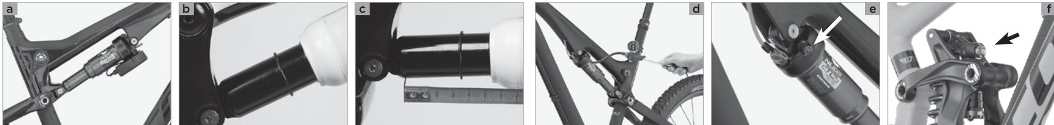
Führen Sie nach jeder Änderung der Einstellung eine Probefahrt durch möglichst vielseitiges Gelände durch. Überprüfen Sie danach die Position des Gummiring/Kabelbinders. Sein Abstand zum Abstreifer ist der maximale Federbeinhub, den Sie genutzt haben.
