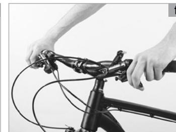
Pendant la première rotation, le levier de serrage RWS de l'axe traversant doit tourner avec souplesse. Lorsque tout est bien installé, tournez le levier de serrage RWS de deux tours et demi maximum au total dans le sens des aiguilles d'une montre pour prétendre le système RWS.
