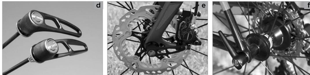
Maintenez l'écrou de serrage sur le côté droit du moyeu. Puis tournez le levier de serrage RWS dans le sens des aiguilles d'une montre pour prétendre le système RWS. En fonction de la fourche installée ou du modèle du cadre, il faudra généralement effectuer six tours, voire plus dans la plupart des cas. Pendant les premières rotations, le levier de serrage RWS doit tourner avec souplesse.
