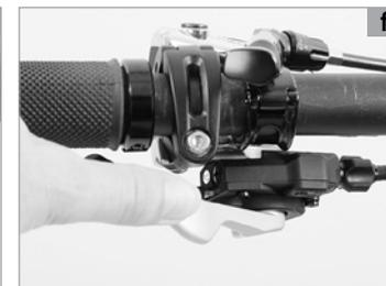
Si les vélos tout terrain SCOTT peuvent avoir jusqu'à 33 vitesses théoriques, vous disposez en réalité de 15 à 18 vitesses en pratique, en raison des recouplements. Les combinaisons de vitesses où la ligne de chaîne croise l'axe longitudinal du vélo sont à éviter, car les frottements produits accélèrent l'usure de la chaîne et limitent le rendement.
