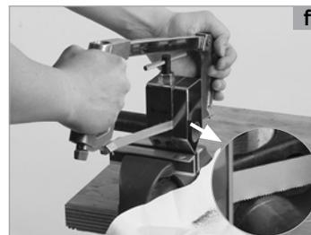
6. Serrez l'expandeur avec une clé Allen de 8 mm en appliquant un couple de serrage de 4-5 Nm au maximum. Assurez-vous que l'expandeur est aligné avec l'arête supérieure du tube de pivot **(a)**. Assurez-vous que l'écart entre le bord supérieur du collier de potence et l'arête supérieure du tube de pivot ne dépasse pas 2,5 mm, voir l'illustration.
