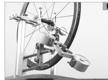
**CENTRADO DE LAS LLANTAS, TENSADO DE LOS RADIOS**
