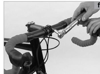
Para **SRAM** ajuste primero los discos de leva integrados en las palancas de cambio, después de echarlas ligeramente hacia atrás y girarlas hacia adentro. A continuación, enrosque el tornillo oculto en el cuerpo de la palanca de freno/cambio, bajo el puño de goma, con una llave Allen.
