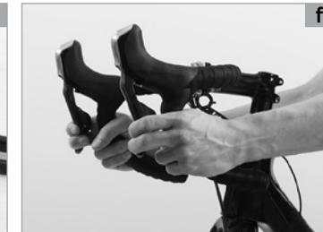
En caso de los frenos de disco **(a)**, el punto de presión debe ser estable de inmediato. Si un punto de presión estable se siente sólo después de accionar varias veces la palanca de freno, deberá dejar controlar inmediatamente la bicicleta SCOTT en su establecimiento especializado SCOTT. Para obtener más información consulte el capítulo “Sistema de frenos” y en las instrucciones de los fabricantes de los componentes, que se incluyen en este CD informativo SCOTT.
