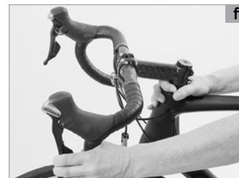
Para comprobar la marcha suave del juego de dirección, levante el cuadro con una mano, hasta que la rueda delantera deje de tocar el suelo. La rueda delantera tiene que girar, sin atascarse, de un extremo a otro y viceversa. A la menor pulsación del manillar, la horquilla debe moverse espontáneamente desde la posición central **(a)**.
