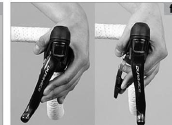
El proceso de cambio se inicia, dependiendo del sistema de cambio que lleve montado la bicicleta, accionando una unidad de palancas de freno/cambio **(c)** o una palanca de cambio **(d)** en caso de un manillar recto (flatbar). Durante todo el proceso de cambio hay que seguir pedaleando; a la vez hay que reducir notablemente la fuerza de pedaleo.
