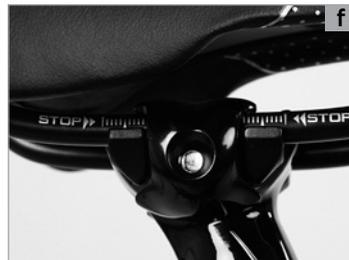
En el caso de **sistemas de un tornillo (c)**, la tija de sillín de la mayoría de los sillines deportivos está diseñada para montar varillas del bastidor de 7 mm de diámetro.
