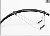
Per motivi di sicurezza sui bracci di sostegno anteriori devono assolutamente essere montati dei dispositivi antistrappo. Questi dispositivi impediscono che i corpi estranei raccolti dallo pneumatico vadano a bloccare la ruota. In questo caso il dispositivo antistrappo sblocca il braccio di sostegno evitando così un possibile incidente. Il connettore ad innesto è facile da reinserire.
