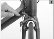
Quando i pattini si usurano, il punto di contatto della leva del freno si sposta verso il manubrio. Verificate regolarmente la corsa a vuoto, che non dovrebbe mai superare un quarto della corsa totale. Per eseguire la regolazione girate il dado zigrinato e/o la vite zigrinata (a) attraverso i quali il cavo passa nel corpo freno, fino a raggiungere il percorso leva desiderato. Quindi eseguite una prova dei freni in una zona poco affollata.
