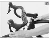
Per verificare la scorrevolezza della serie sterzo, sollevate con una mano il telaio in modo che la ruota anteriore non sia più a contatto con il suolo. La ruota anteriore deve oscillare da un estremo all'altro in maniera scorrevole e senza bloccarsi. Toccando leggermente il manubrio, la forcella deve spostarsi automaticamente dalla posizione centrale (a).
