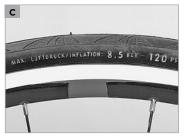
Gli pneumatici rigidi e pieghevoli ed il cerchio di per sé non sono a tenuta d'aria. Per mantenere la pressione all'interno si inserisce una camera d'aria (f) gonfiata per mezzo di una valvola.
