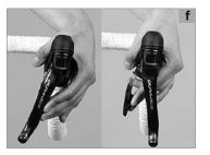
Nel caso di leve cambio-freno **SRAM** il cambio è costituito solamente da una leva del cambio **(a)** posizionata dietro la leva freno. Spostando completamente la leva, il cambio passerà a uno o due ingranaggi o tre pignoni più grandi. Con un breve azionamento la catena passa all'ingranaggio o al pignone più piccolo.
