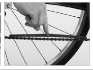
La sostituzione di questi componenti è di gran lunga più costosa di una sostituzione delle catena. Verificate, pertanto, ad intervalli regolari lo stato della catena.
