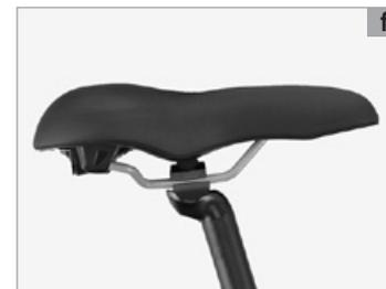
Si la selle est compatible, avancez ou reculez-la de manière que les rails soient serrés au centre par le mécanisme de serrage de la tige **(a)**. Ajustez, en outre, le bord supérieur de la selle de façon parallèle au sol. Serrez les boulons progressivement et assurez-vous que
