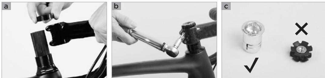
4. Appliquez un peu de graisse régulièrement sur les paliers avant de monter la fourche dans le cadre. Évitez tout contact de graisse sur les surfaces de fixation de la potence. Un serrage fiable de la potence ne sera éventuellement plus possible. Appliquez de la pâte de montage pour composants carbone spéciale à l'intérieur de la potence et à l'intérieur et l'extérieur du pivot de fourche dans la zone de serrage, afin d'obtenir une adhérence optimale et d'optimiser la prise du serrage.
