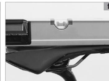
Une fois déterminée la position idéale, vérifiez que les rails de la selle sont correctement engagés dans les glissières du chariot avant de serrer les vis au couple de serrage recommandé par le fabricant de la tige de selle.
