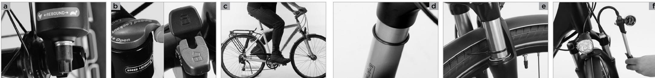
Sur la plupart des fourches suspendues équipées de ressorts acier, il est possible de précontraindre le ressort, dans une mesure limitée, à l'aide d'une molette de réglage placée sur le té de fourche **(a)**. Dans le cas contraire, et si le débattement négatif ne peut pas être réglé comme souhaité, vous devrez remplacer les ressorts acier par des ressorts plus durs ou plus mous. Ce remplacement doit être confié à votre vélociste SCOTT.
