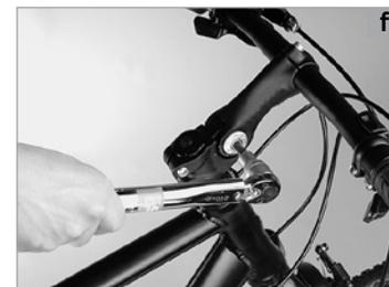
Contrôlez le bon serrage de la potence en calant la roue avant entre les jambes et en essayant de faire pivoter la potence et le cintre latéralement **(d)**. Si la potence bouge, augmentez la force de serrage sur la vis. Ne dépassez pas le couple de serrage maximum.
