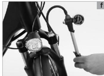
Nella maggior parte delle forcelle ammortizzate con molle in acciaio è possibile pretensionare l'ammortizzatore, seppur limitatamente, tramite un una vite di regolazione collocata sulla testa della forcella **(a)**. Se così non fosse e se non è possibile registrare la corsa negativa desiderata, è necessario sostituire la molla in acciaio con un pezzo simile più duro o più morbido. La sostituzione è un'operazione da affidare al rivenditore specializzato SCOTT.
