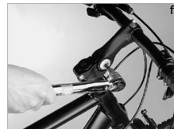
Verificate la sede dell'attacco manubrio tenendo la ruota anteriore tra le ginocchia e provando a girare il manubrio e l'attacco manubrio **(d)**. Se dovesse girarsi, aumentate la coppia di serraggio della vite. Non superate la coppia di serraggio massima.
