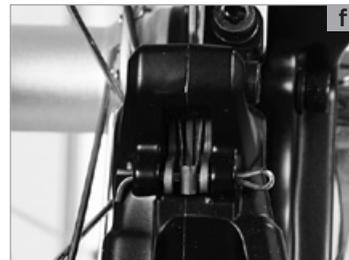
Per freni V-Brake e Cantilever, riagganciate il cavo al braccio del freno. Con una mano afferrate la ruota e spingete i pattini o i bracci del freno gli uni contro gli altri. Questa posizione facilita lo sgancio del nipplo a forma di botte **(e)**.
