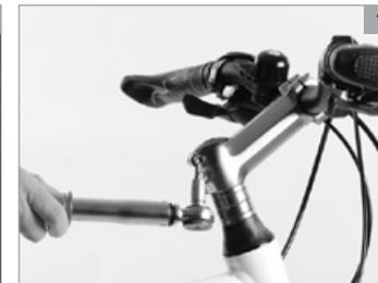
Per mettere a testa in giù l'attacco manubrio è inoltre necessario svitare le viti anteriori di fissaggio del manubrio **(d)**. Nel caso di attacchi manubrio con tappo è necessario semplicemente estrarre il manubrio. Altrimenti è necessario smontare le armature del manubrio.
