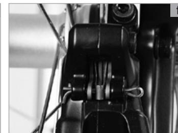
Coloque o cabo, em V-brakes e travões Cantilever, novamente no braço do travão. Envolve o aro com uma mão e comprima os calços ou os braços de travagem, um contra o outro. Nesta posição é possível suspender facilmente a conexão, quase sempre com forma cilíndrica **(e)**.
