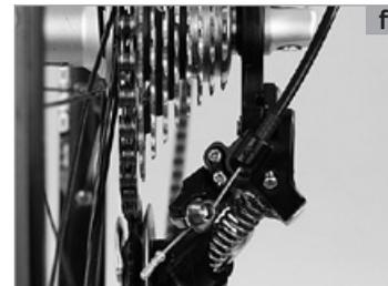
Corrija a posição eventualmente com o parafuso do batente final. Nos desviadores traseiros, os parafusos estão marcados frequentemente com “H” para “high gear” e “L” para “mudança baixa”. “High gear” significa neste caso a mudança pesada, ou seja o pinhão pequeno. Rode o parafuso no sentido dos ponteiros do relógio, se for suposto o desviador traseiro circular mais no interior ou no sentido contrário aos ponteiros do relógio, se for suposto ele circular mais no exterior **(e)**.
