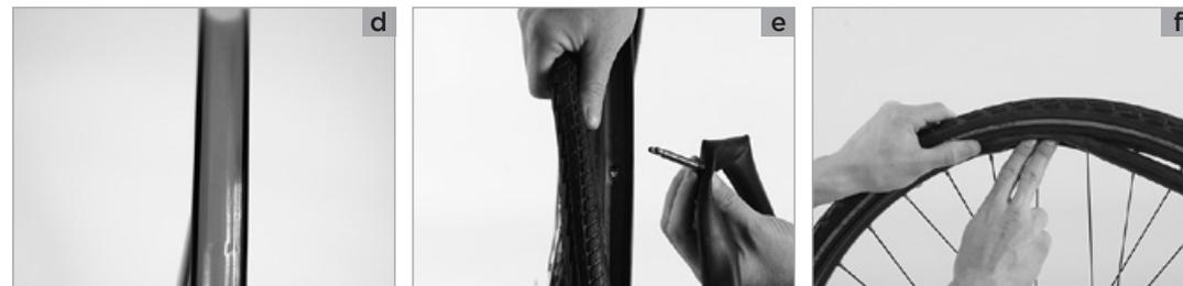
Vá avançando, homoganeamente, dos dois lados, a toda a volta. Quase no fim, tem de puxar o pneu com força para baixo **(a)**, para que a parte já montada escorregue para o fundo do aro. Isto facilita visivelmente a montagem nos últimos centímetros.
