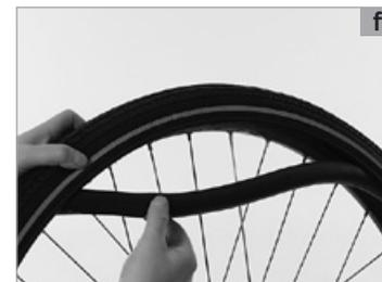
Para asegurarse de que la cámara no queda aplastada por el aro del neumático, mueva el neumático de un lado a otro, en toda la circunferencia de la rueda. Aproveche para comprobar que la cinta fondo de llanta no se haya desplazado.
